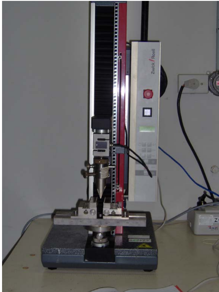
Figura 3.3.7.1 – Equipamento utilizado nas medidas de resistência mecânica.
