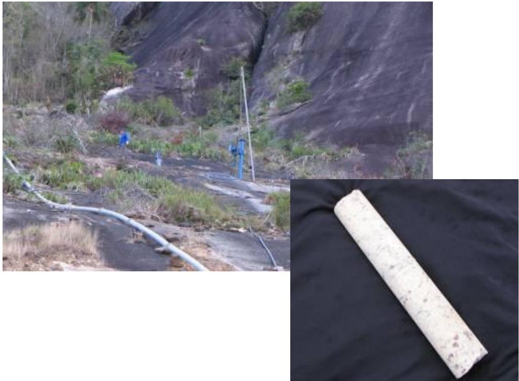
*Figura 17 e 18 – sondagem na rocha e o testemunho para análise e avaliação mercadológica.*
