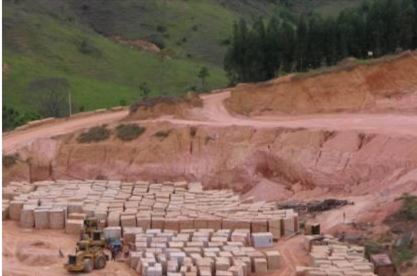
*Figura 32 – Blocos nas 02 dimensões na praça de estocagem.*
