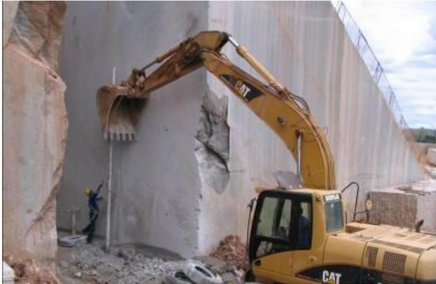
*Figura 21 – abertura de gaveta e instalação de torre para máquina de fio diamantado.*
