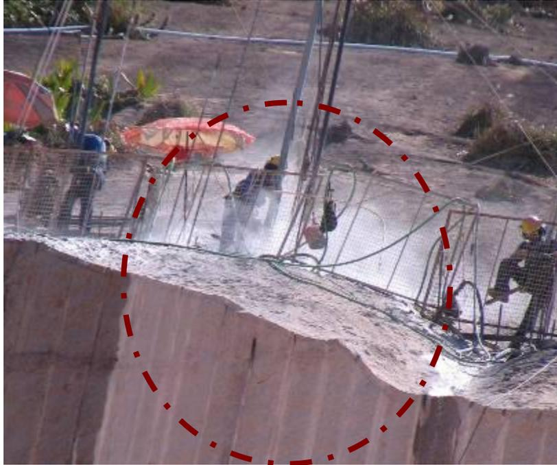
*Figura 02 - processo de utilização dos marteletes mecânico pneumático sem água.*
