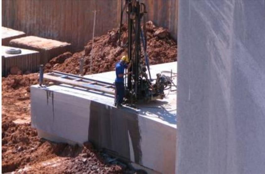
*Figura 11 – operador de perfora.*
