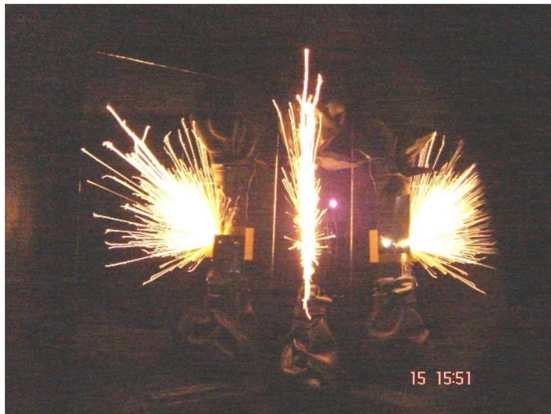
Figura 2 - Ocorrência de Centelha em junção de CFC.
