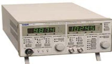
O laser é controlado por uma fonte modelo ITC502 com faixa de corrente laser Ild de 200mA.
