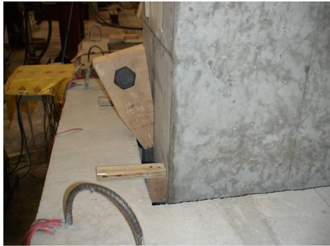
Figura 4.20 - Fixação temporária com utilização de uma cunha
