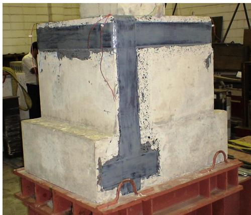
Figura 3.9 - Reforço aplicado nos cálices ensaiados por Ebeling (2006)
