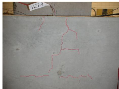
Figura 4.25 - Fissuras na parede transversal posterior
