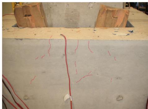
Figura 4.24 - Fissuras na parede transversal frontal
