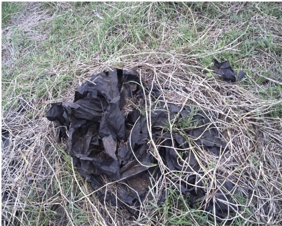
**Figura 36** - Geomembrana solta do aterro desativado na Linha Olinda, em Coronel Freitas.
