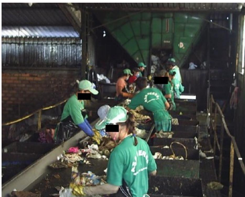
**Figura 67** - Centro de triagem de resíduos, esteira de separação no aterro sanitário do município de Xanxêre. Fonte: RUARO, 2007.
