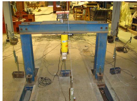
Figura 3.26 – Esquema e vista do pórtico de reação
