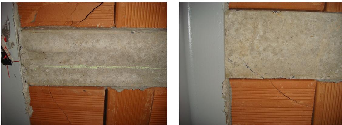
Figura 4.66 – Vista da ruptura das lajotas e vigotas - 9ª etapa de carregamento concentrado
