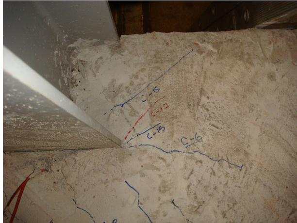
Figura 4.51 – Fissuras ao redor do pilar de canto - 7ª etapa de carregamento concentrado
