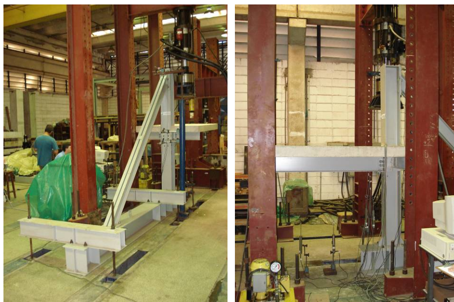
Figura 4.14 – Visão geral do protótipo isolado de pilar de borda.
