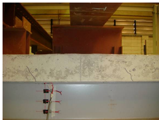
Fissuração na espessura da laje
