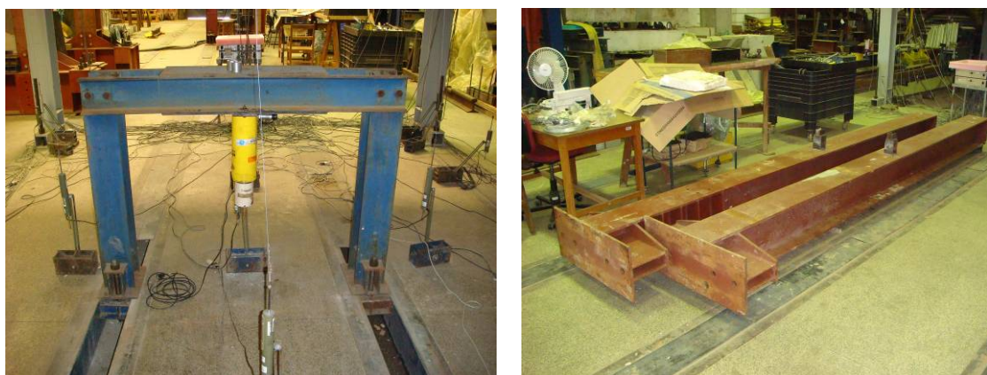
Figura 4.32: Pórtico de reação sob a laje do pavimento tipo e perfis de elevada rigidez para aplicação do carregamento concentrado.
