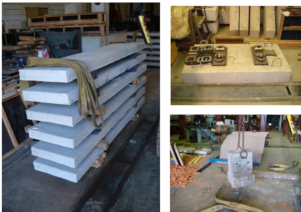
Figura 4.29: Visão geral das peças pré-moldadas utilizadas na etapa de carregamento distribuído do pavimento tipo.
