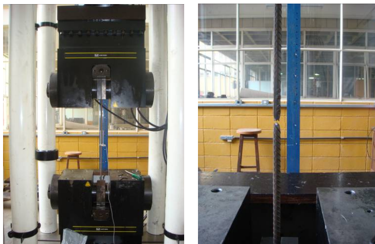
Figura 4.42: Ensaio de caracterização do aço das armaduras.
