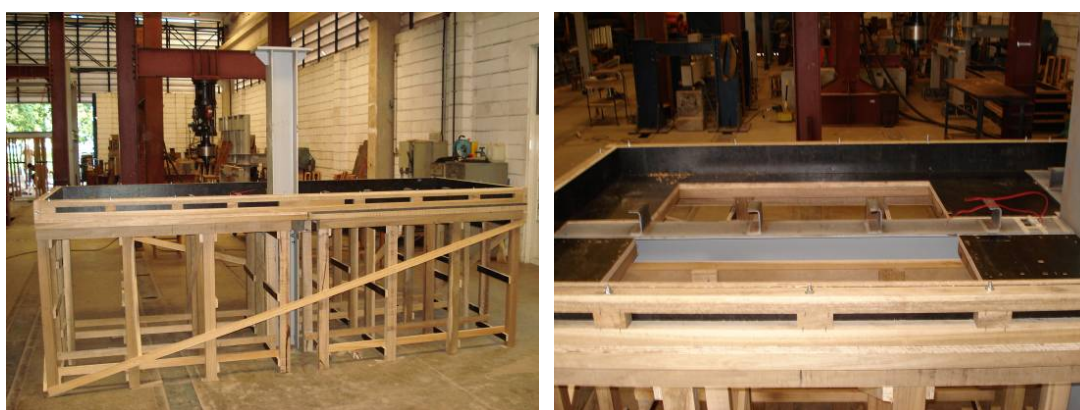
Figura 4.8: Montagem das formas no modelo cruciforme.
