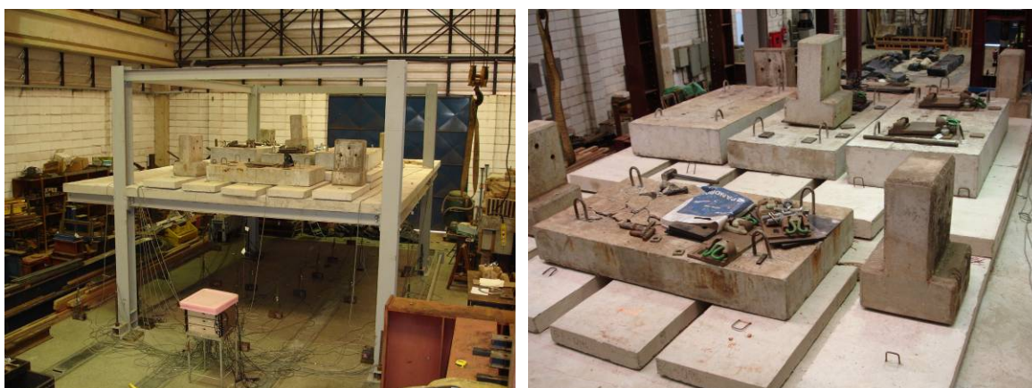
Figura 4.30: Visão geral da última fase da etapa do carregamento distribuído.
