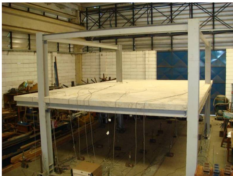
Figura 4.40: Transdutores posicionados sob a laje do pavimento tipo antes da primeira etapa de carregamento distribuído.
