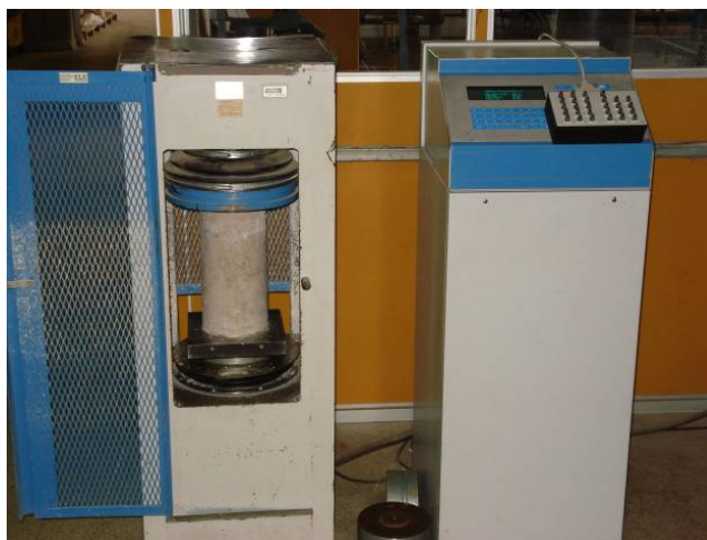
Figura 4.41: Ensaio de caracterização dos corpos de prova de concreto.
