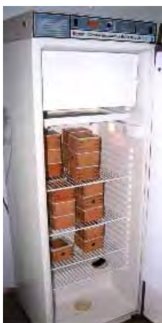
Figura I: Estufa B.O.D, reguladora de temperatura e umidade, com as caixas de abelhas em experimento.
