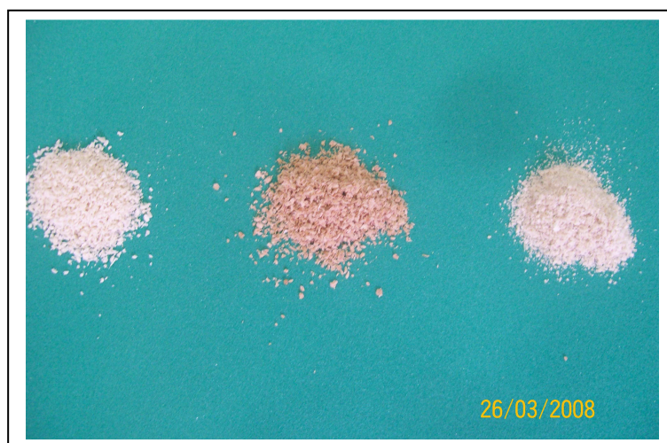
FIGURA 26-PECTINA EXTRAÍDA DO ALBEDO CÍTRICO, BAGAÇO DE MAÇÃ E MESOCARPO DE MARACUJÁ-AMARELO (DA ESQUERDA PARA A DIREITA).
