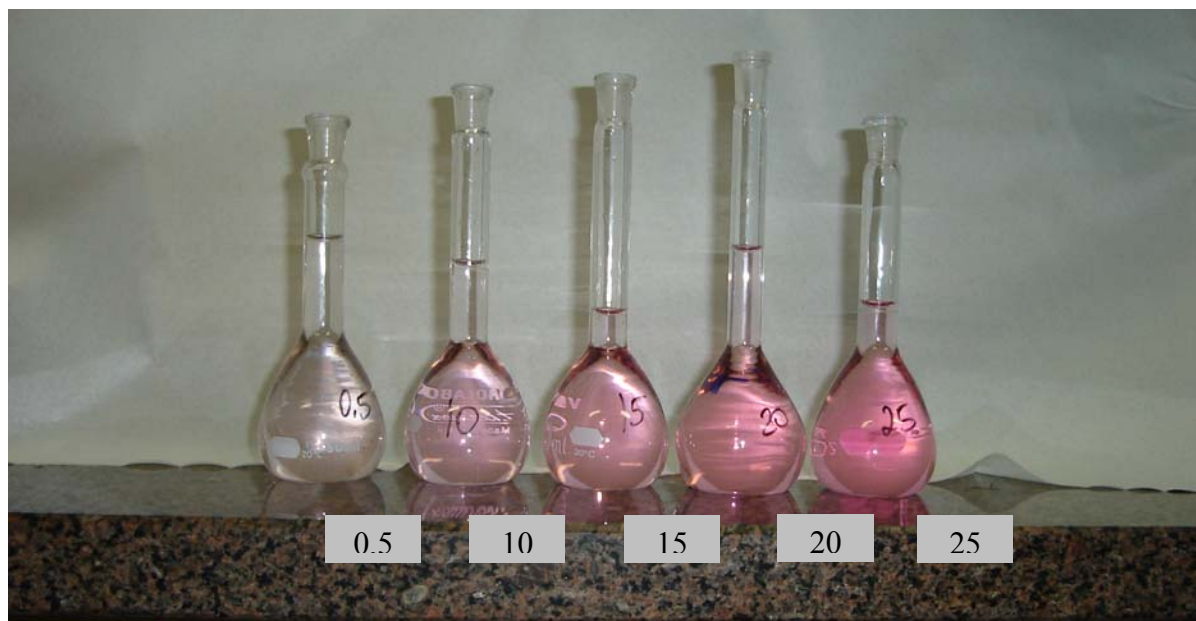
Figura 12 - Visualização das diferenças de coloração nas amostras com 0,5; 10; 15; 20 e 25 mL de concentrações de nitrito para a construção da curva padrão. ESALQ/USP, Piracicaba-SP
