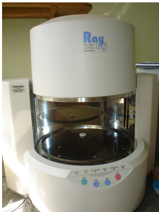
Figura 10 - Equipamento espectrômetro de fluorescência de raio X, da marca Shimadzu Co., modelo EDX-720
