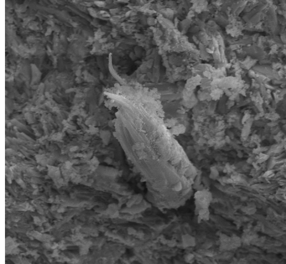
Figura 46 - Superfície de ruptura do compósito com fibras de polivinil álcool (PVAL) conformado pelo método UCOS (aumento de 1000x) – Ruptura das fibras de PVAL.
