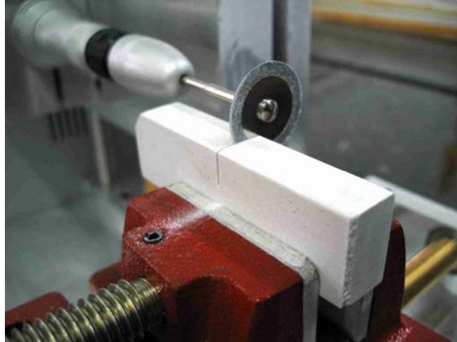
Figura 17 - Entalhe para determinação de K_{Ic} pelo ensaio de SENB.
