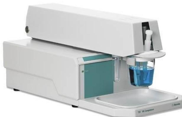
Figura 3: Polarógrafo METROHM modelo 797.
