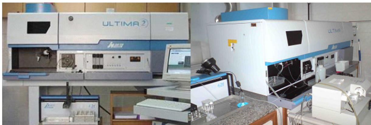
Figura 5: Sistema de ICP-OES, modelo ULTIMA 2 da Jobin-Yvon.
