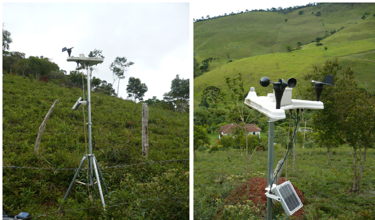
FIGURA 3. Estação climatológica instalada na bacia hidrográfica do ribeirão Lavrinha para o monitoramento climático.
