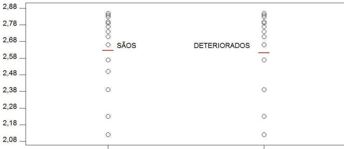
FIGURA 11.22 – Valores de I_{ig,simplificado} para postes SÃOS e DETERIORADOS
