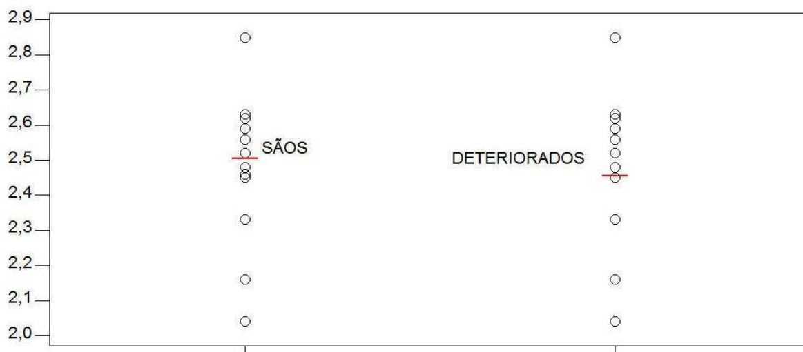
FIGURA 11.21 – Valores de I_{ig} para postes SÃOS e DETERIORADOS
