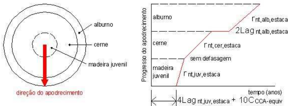
FIGURA 7.13 – Progresso do apodrecimento externo para postes tratados de hardwood – (LEICESTER et al.,2003)
