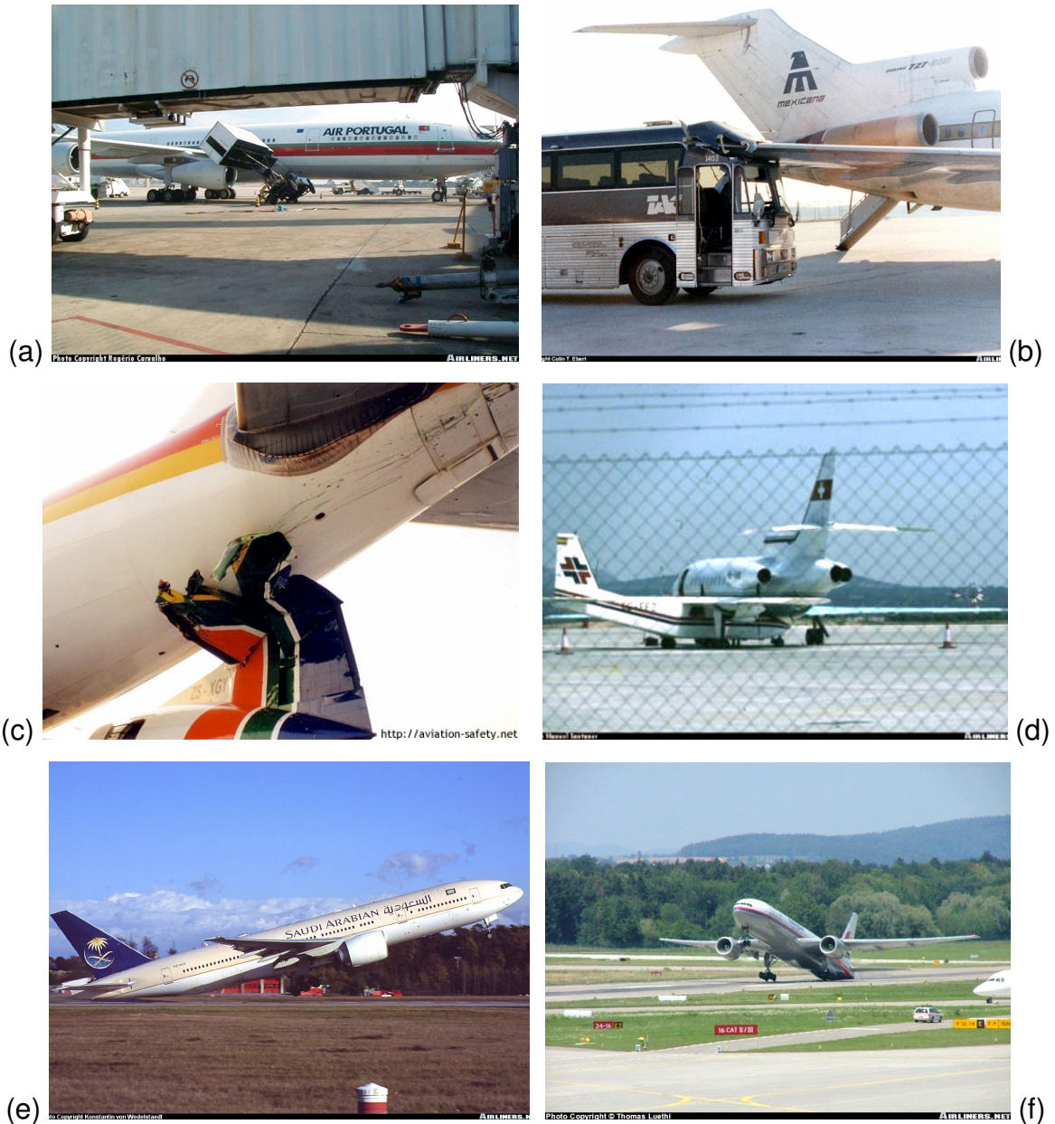
Figura 1.1 - (a,b) Choques de veículos circulando pela pista com aeronaves estacionadas; (c,d) Impacto entre duas aeronaves taxiando em solo; (e,f) Eventos de tail-strike durante testes de aeronaves (ROB PHOTOS, 2007).
