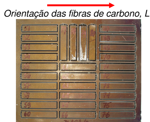
Figura 3.6 - Chapa de TiGra após usinagem dos corpos de prova tipo Charpy.
