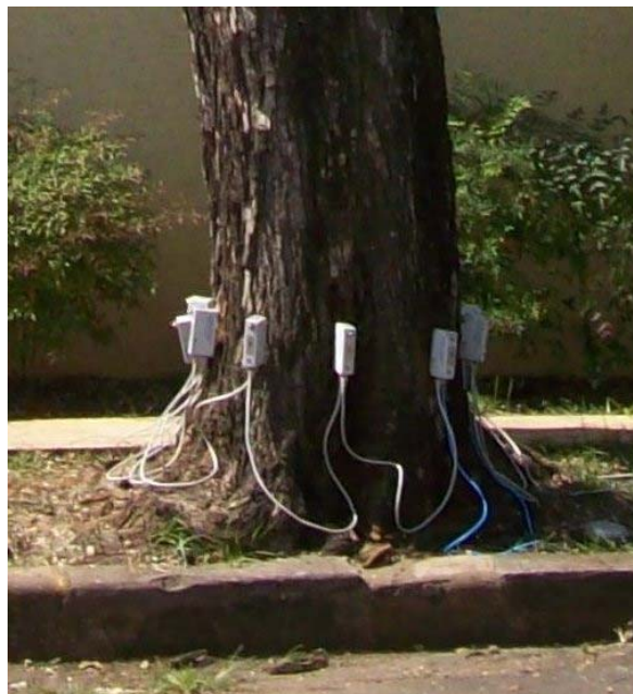
Figura 2 - Tomógrafo de impulso montado para avaliação de árvore
