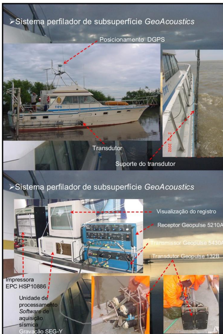
Figura 13: Sistema GeoAcoustics utilizado na aquisição e processamento em tempo real dos dados sísmicos.
