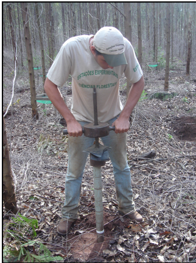
Figura 5 – Sistema de coleta das amostras de "solo-raízes" com sonda de inox, em parcelas experimentais de Eucalyptus grandis
