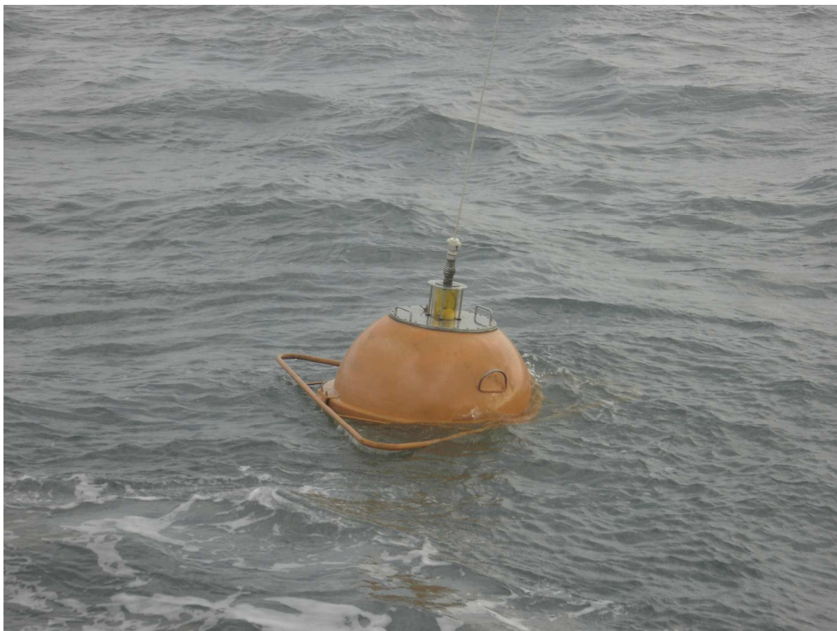
Figura 3. Ondógrafo fundeado no litoral norte do Rio Grande do Sul.
