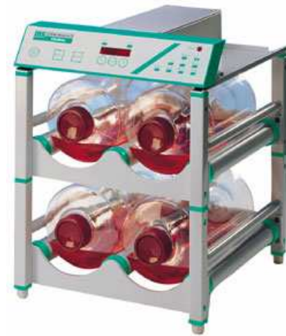
Figura 1.10: Garrafas roller . (a) visão geral das garrafas de 850 cm 2 de superfície interna, como as utilizadas neste trabalho; (b) disposição das garrafas quando em processo de cultivo, sobre o aparelho gerador de rotação (Greiner Bio-One, 2009).
