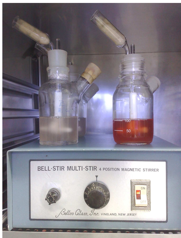
Figura 3.2: Sistema empregado no cultivo do hibridoma secretor do anticorpo monoclonal anti-dengue tipo 2 em frascos agitados do tipo spinner .
