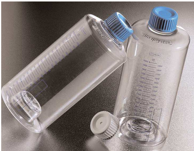
Figura 1.10: Garrafas roller . (a) visão geral das garrafas de 850 cm 2 de superfície interna, como as utilizadas neste trabalho; (b) disposição das garrafas quando em processo de cultivo, sobre o aparelho gerador de rotação (Greiner Bio-One, 2009).
