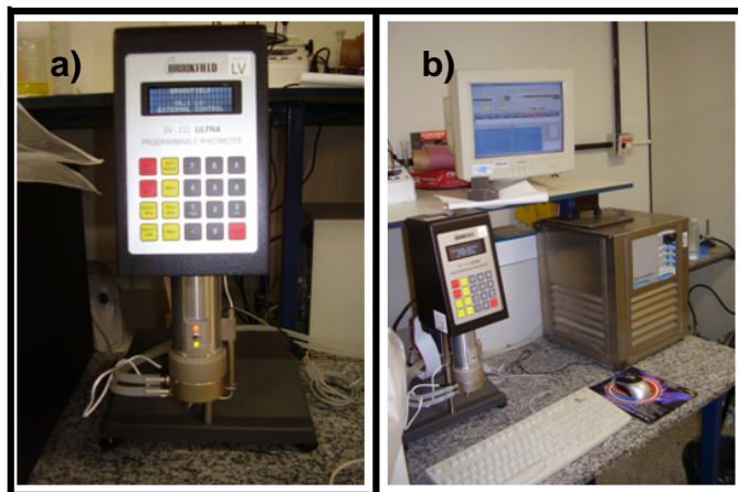
Figura 27 – a) Reômetro Brookfield, b) esquema utilizado para medir a viscosidade das amostras de óleo de dendê: o viscosímetro, banho e software de computador.
