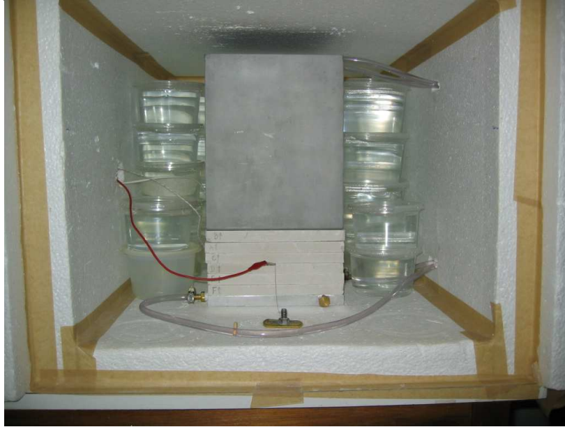
Figura 7. Caixa térmica usada para manter constante a temperatura do ambiente de medida das amostras.
