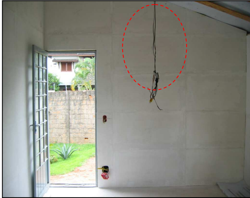
Figura 18. Monitoramento da temperatura da sala de estar, com destaque para o ponto de leitura do termopar.
