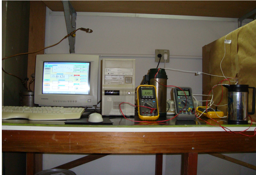
Figura 5. Instrumentação usada para medição da condutividade térmica pelo método do fio quente
