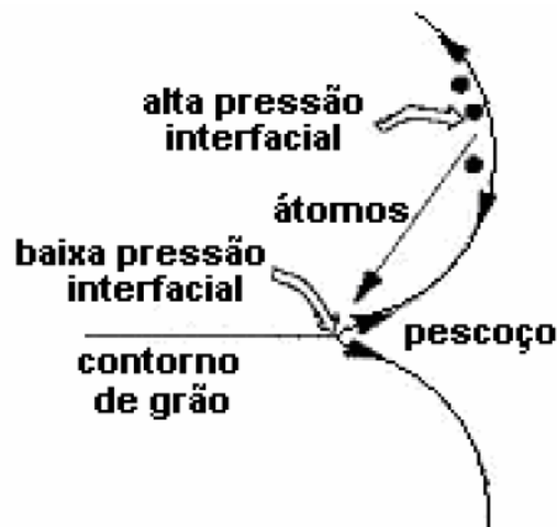
Figura 2.6 – Formação dos pescoços a partir do fluxo de átomos entre regiões com diferentes curvaturas, de acordo com o gradiente de pressão entre estas regiões (28).
