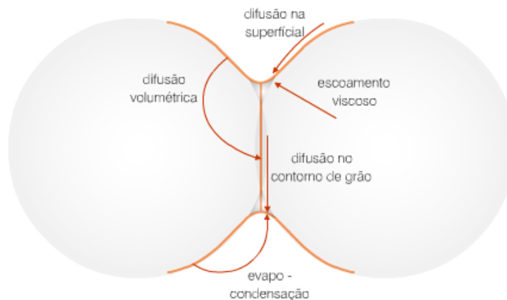
Figura 2.4 – Mecanismos de transporte de massa no processo de sinterização por fase sólida: evaporação/condensação, escoamento viscoso, difusão superficial, difusão volumétrica, difusão pelo contorno de grão.
