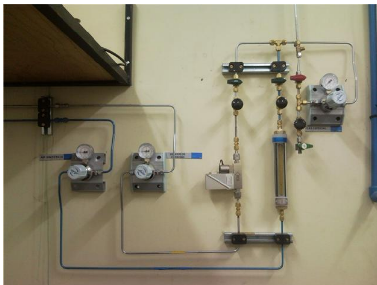
Figura 3.20: Sistema montado para realizar a mistura e controle dos gases.
