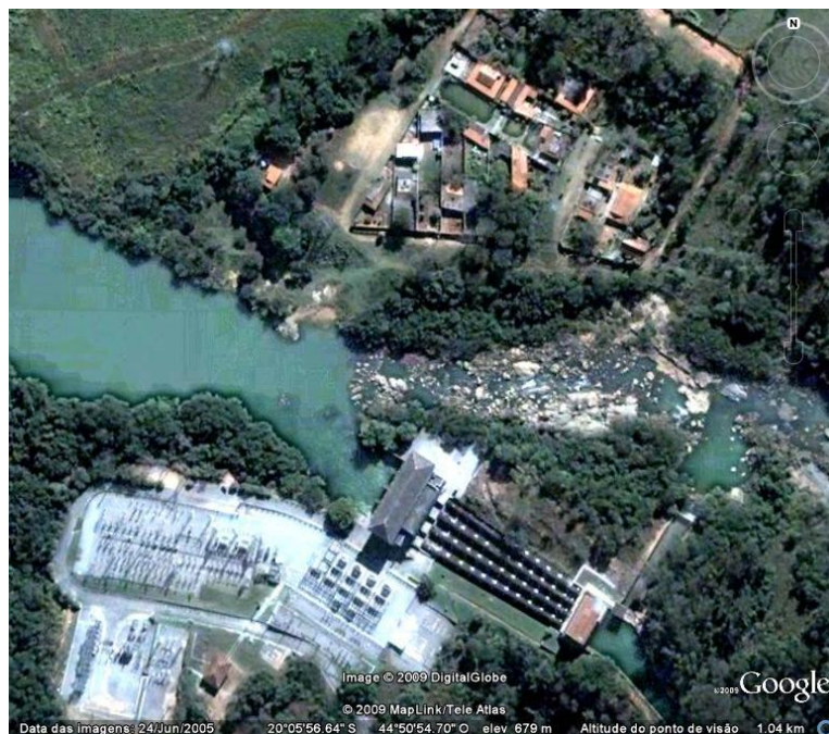
Figura 2: Usina Hidrelétrica (UHE) de Gafanhoto, Divinópolis, Minas Gerais. Instalada no rio Pará com início de operação em 1946. Tem potência de 14,00MW e volume útil de 3,95hm 3 .
