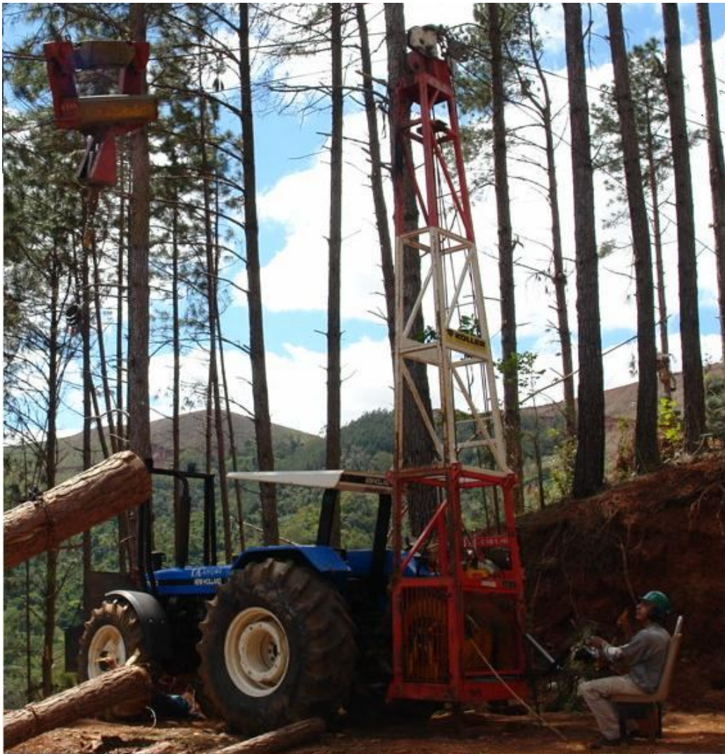
Figura 5-Cabo aéreo da marca Koller, modelo K300.
