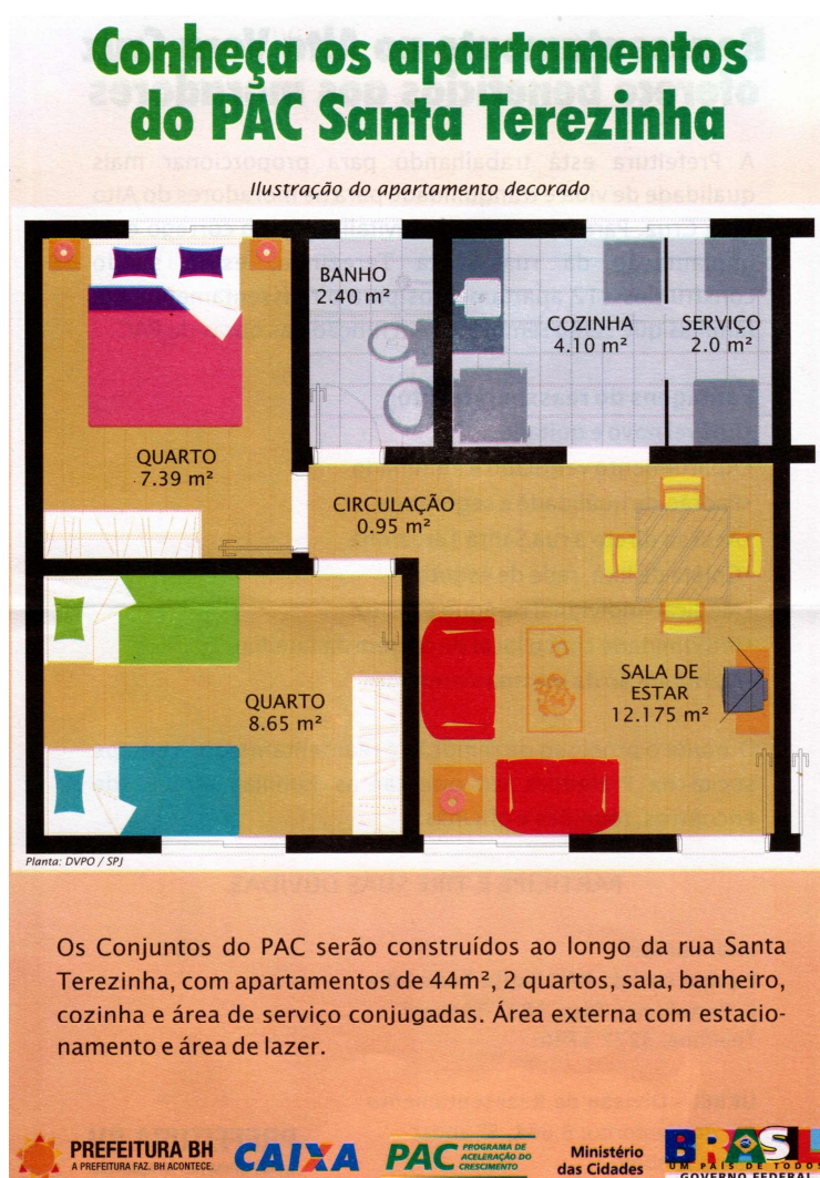
Figura 08: Ilustração da planta utilizada como padrão da construção dos apartamentos do Condomínio Santa Terezinha.
