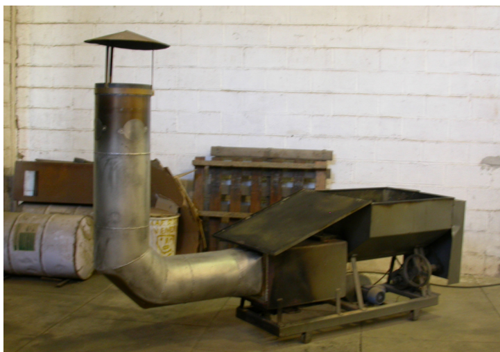
(a) Detalhe da chaminé na extremidade da câmara de combustão
