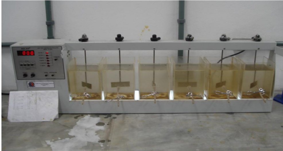
Figura 5.5 Ensaio ETA Mata do Seminário utilizando as dosagens 5, 10, 15, 20, 25 e 30mg/L de coagulante cloreto férrico, com turbidez 200uT.
