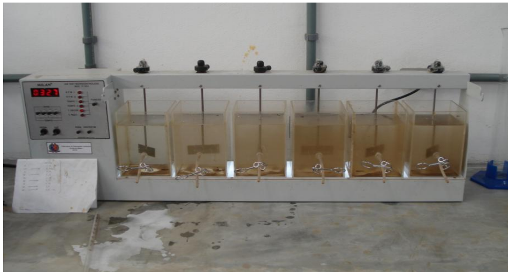
Figura 5.4 Ensaio ETA Mata do Seminário utilizando as dosagens 5, 10, 15, 20, 25 e 30mg/L de coagulante sulfato de alumínio, com turbidez 200uT.
