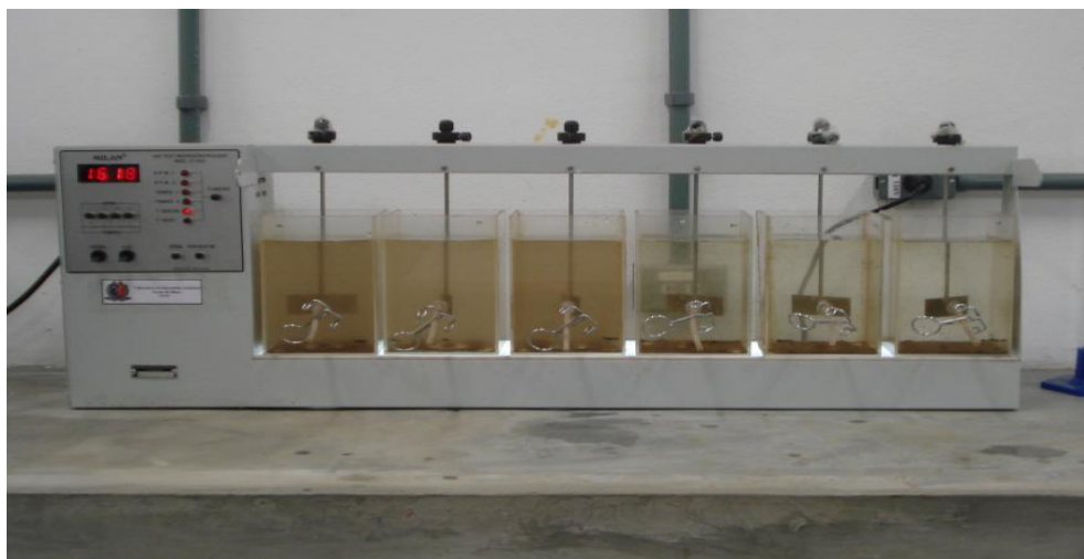
Figura 5.8 Ensaio na ETA Funil utilizando nos três primeiros jarros dosagens de 5,10 e 15mg/L de sulfato de alumínio nos três últimos dosagens de 5,10 e 15mg/L de cloreto férrico.
