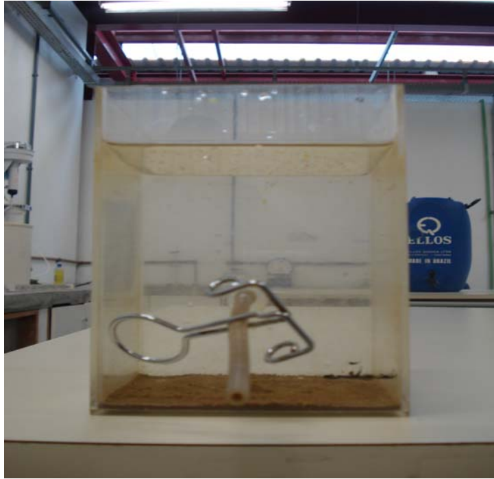
Figura 5.11 Jarro do ensaio 200uT tendo como a melhor dosagem 30 mg/L para o cloreto férrico, para a ETA Funil
