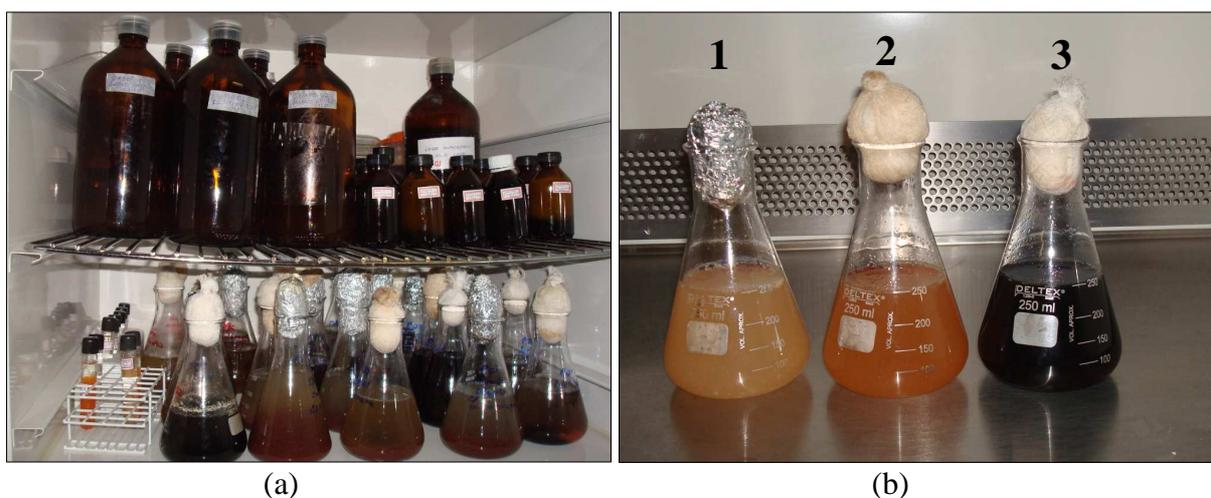
Figura 5.10 - Enriquecimento de BRS das amostras coletadas em meio líquido Postgate C “modificado”. (a) Enriquecimento e cultivo das amostras e (b) crescimento das culturas de BRS: (1) inóculo em  $t = 0$  h, (2) inóculo em  $t = 24$  h e, (3) inóculo em  $t = 72$  h.
