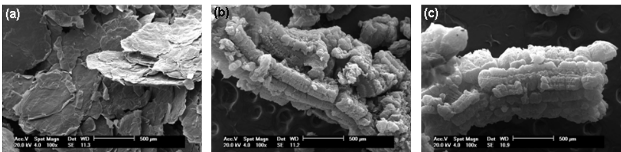
Figura 5.1. Imagens de MEV no modo SE: (a) GE no forno a 5 segundos, (b) GN no forno a 15 segundos e (c) GE no forno a 30 segundos.
