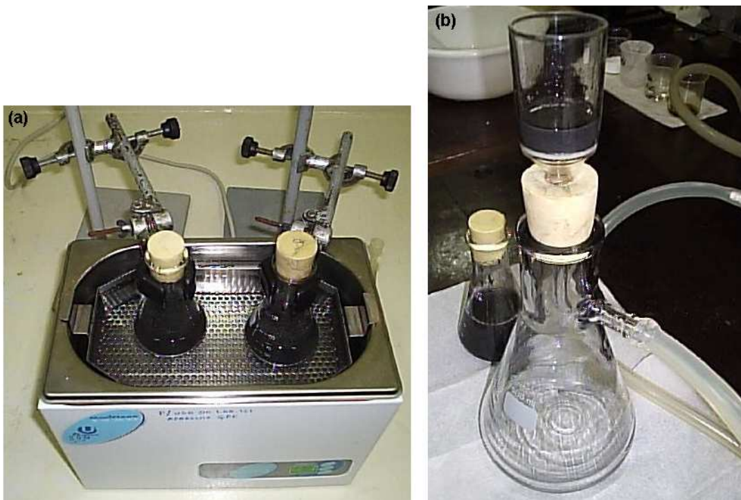
Figura 4.1. Preparação das nanolâminas de grafite: (a) grafite imersa em solução alcoólica no aparelho de ultrassom e (b) filtragem em funil sinterizado.
