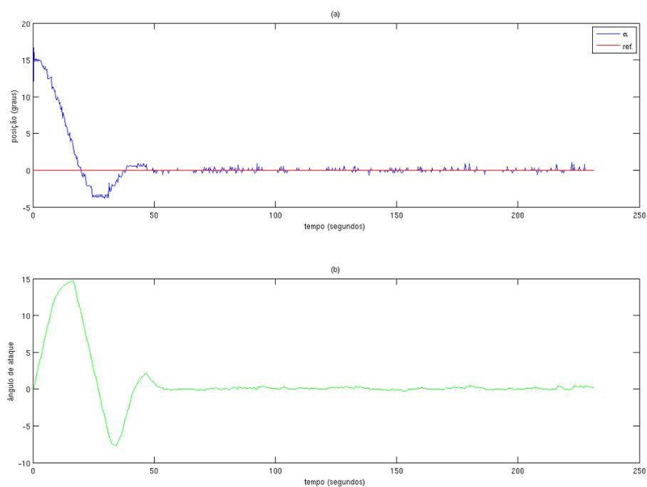
Figura 5.14: Controle PID - Cabos em disposição reta:(a)Erro de posição; (b)Variação do ângulo de ataque das rodas.
