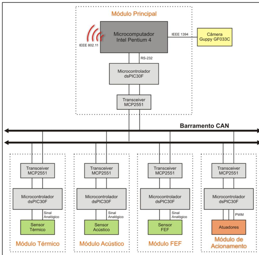
Figura 3.10: Arquitetura do sistema de hardware embarcado.
