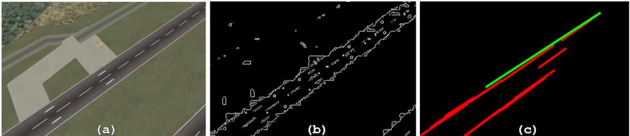
Figura 2.6: (a) Imagem do simulador; (b) Extração de bordas; (c) Identificação de retas.
