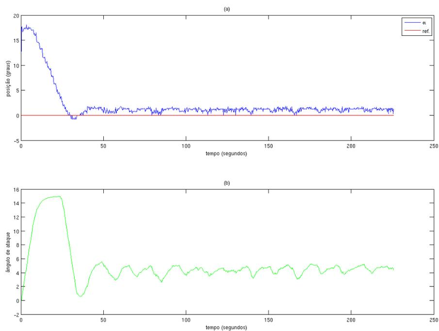
Figura 5.15: Controle PID - Cabos em disposição helicoidal:(a)Erro de posição;
