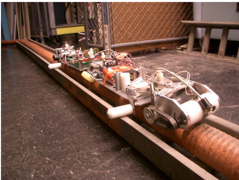
Figura 2.3: Robô autônomo para inspeção de linhas subterrâneas.
