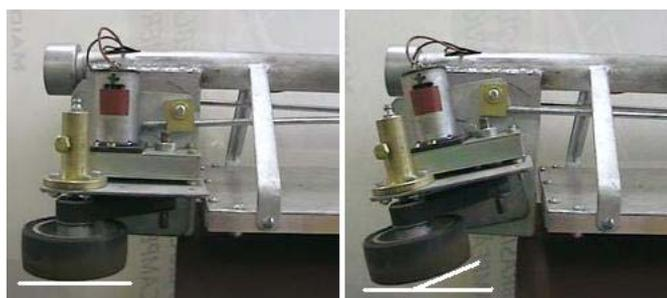
Figura 3.8: Rotação da base das rodas motrizes.
