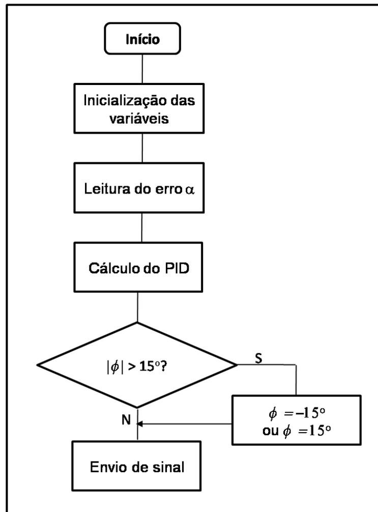
Figura 4.16: Fluxograma representando o algoritmo de controle.
