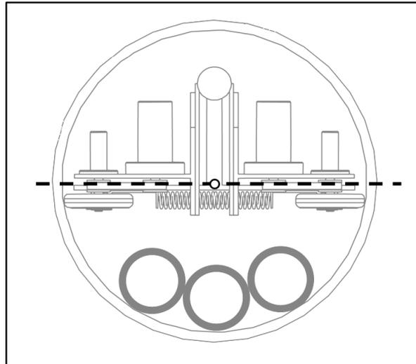
Figura 4.12: Corda, em tracejado, cruzando o centro do duto e alinhada com a base do robô.
