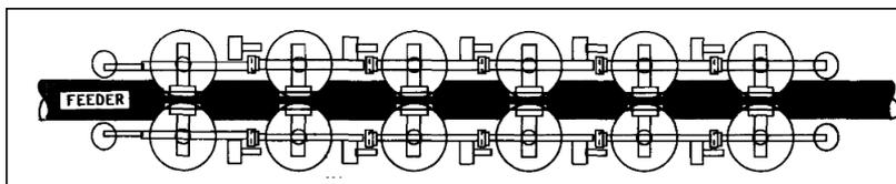
Figura 2.2: Robô multi-bases para inspeção de linhas aéreas com navegação bio-inspirada.
