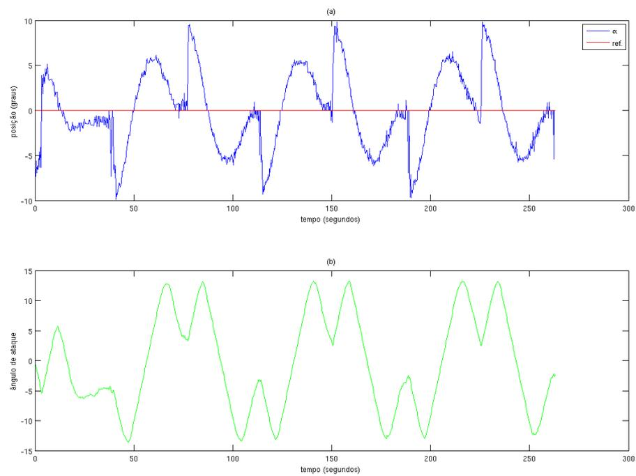
Figura 5.16: Controle PID - Cabos em disposição helicoidal variável:(a)Erro de posição;
