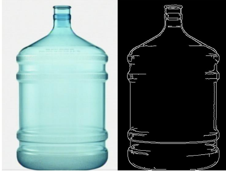
Figura 4.4: (a) Imagem original (b) Imagem com bordas extraídas após aplicação do algoritmo de Canny.
