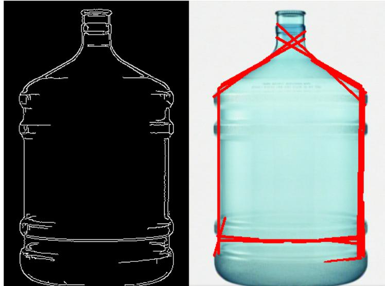
Figura 4.6: (a) Imagem com bordas detectadas (b) Imagem com retas identificadas.
