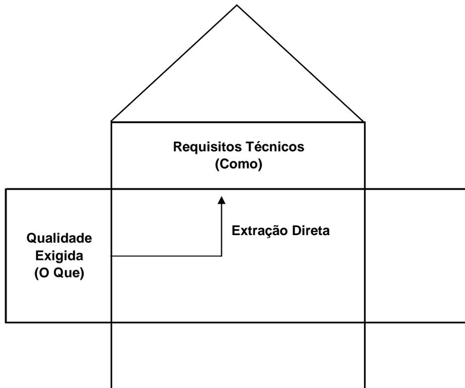
Figura 9 – Obtenção dos requisitos técnicos a partir da qualidade exigida
