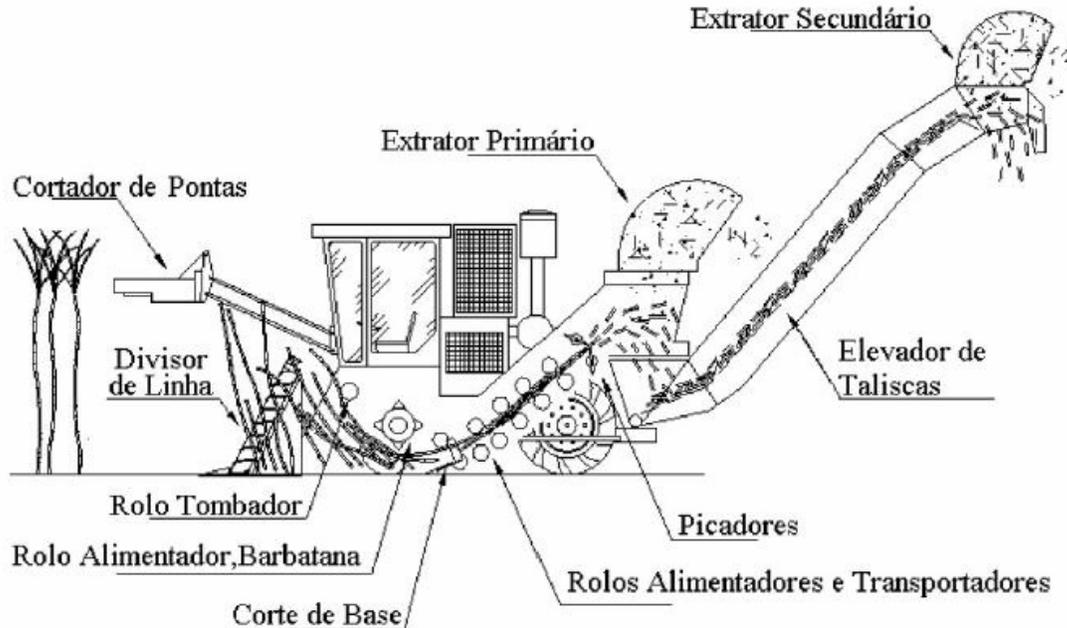
Figura 4 – Principais componentes de uma colhedora combinada automotriz
