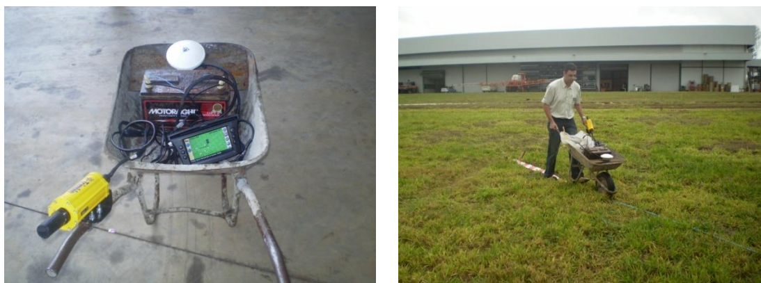
Figura 13 - Montagem do guia por barras de luzes e as antenas de GPS e do rádio que recebe o sinal de correção RTK no carro-de-mão (a) e contorno das áreas para geração dos arquivos para o ensaio do controlador automático de seção e pulverização (b)
