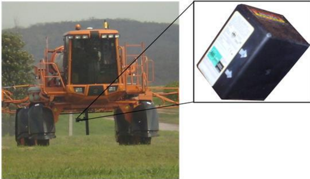
Figura 5 - Sensor de radar de velocidade e posição de fixação no centro do eixo traseiro do pulverizador autopropelido
