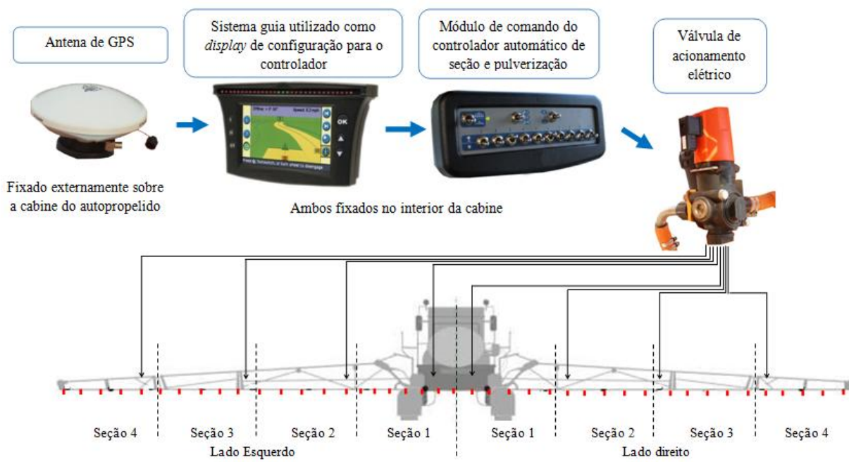
Figura 4 - Esquema de montagem do controlador automático de seções e pulverização e suas respectivas posições de fixação
