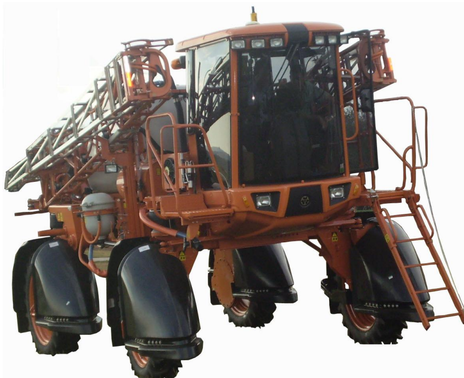
Figura 3 - Pulverizador autopropelido (Uniport 2500 Star ® ) no qual foi instalado o equipamento controlador automático das seções da barra de pulverização submetido ao ensaio
