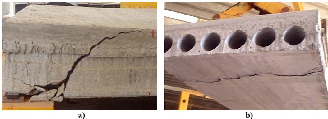
Figura 4.19: Abertura de fissura da laje da Lote A: a) Vista lateral; b) Vista inferior.
