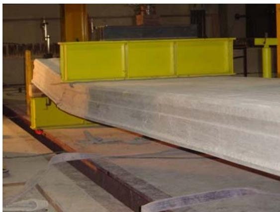
Figura 3.19: Ensaio de Interação de Cisalhamento e Flexão realizado no Laboratório NETPRE-Ufscar.
