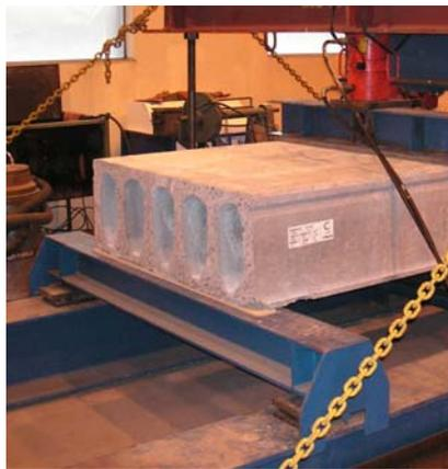
Figura 3.4: Uso de uma faixa de madeira na interface da laje e da viga metálica de apoio [VTT (2006)].
