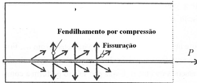
Figura 2.11: Tensões geradas no concreto na região de introdução da protensão [Åkesson (1993)].
