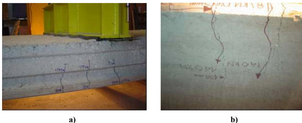
**Figura 4.28:** Configuração de fissuração da laje L12-20-SC-8\_B: a) Vista lateral da região central da laje; b) Vista da superfície inferior da laje.
