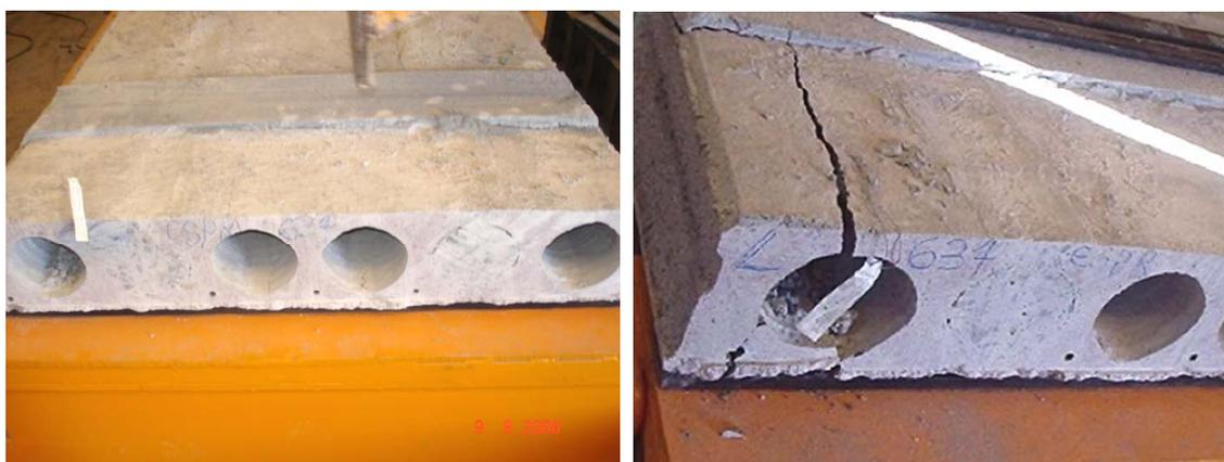
Figura 4.40: Falha por torção em nervura da extremidade (dois alvéolos preenchidos).
