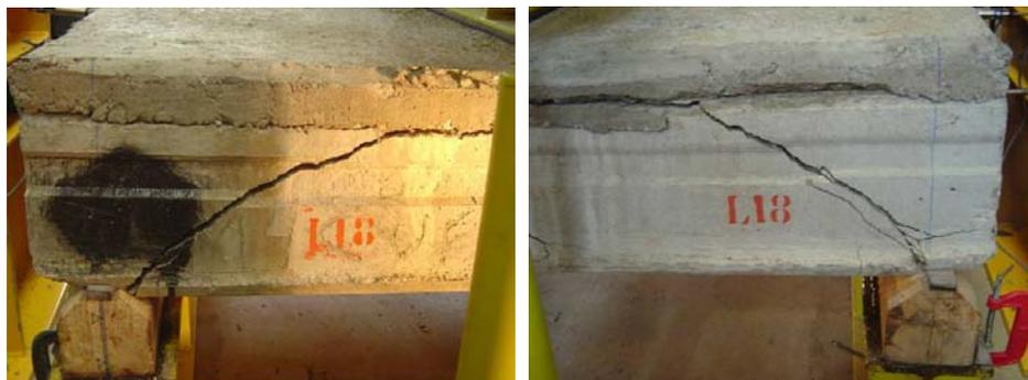
**Figura 4.24: Fissuração da laje L18-CC-6\_C.**
