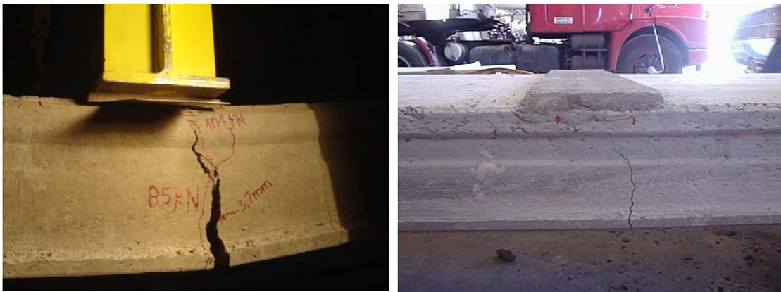
Figura 2.3: Fissuras de flexão em elementos de laje alveolar.
