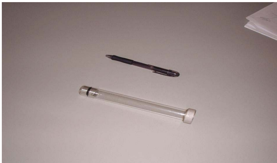
Figura 4.1.2a – Ampola gasométrica de 30 mL.
