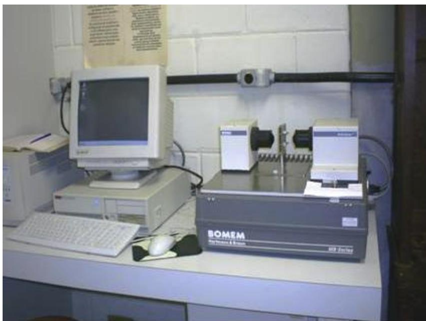
Figura 3.5 – Espectrofotômetro ( FT-IR – BOMEM) empregado para análise do grau de conversão das resinas
