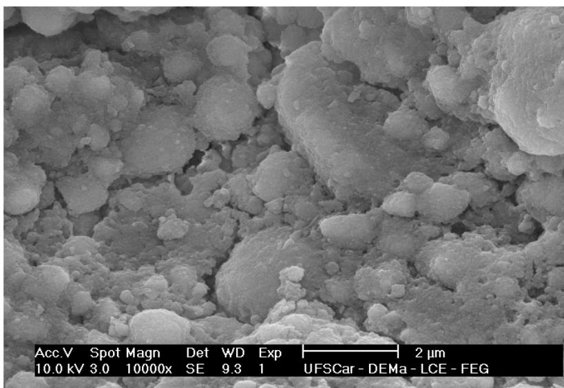
Figura 4.23 – Resina D, fotopolimerizada com 30s. Detalhe do desgaste ocorrido com ampliação de 10000x.
