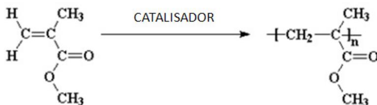
Figura 2.1 – Polimerização do metil metacrilato por mecanismo de adição para formação do poli (metil metacrilato), (adaptado de PEUTZFELDT, 1997).
