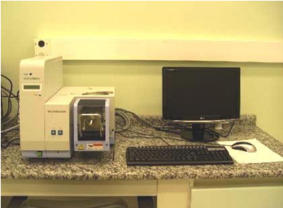
Figura 3.6 – Equipamento utilizado para a Análise de Termogravimétrica (TGA)
