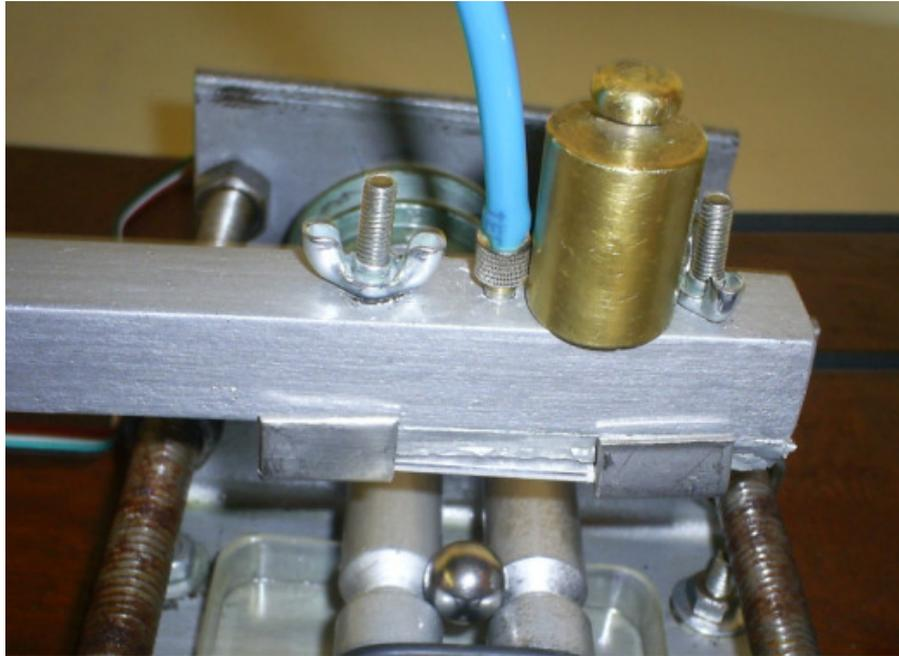
Figura 3.9 – Vista superior do sistema de desgaste abrasivo por esfera rotativa.
