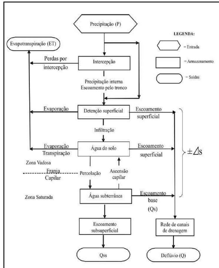
FIGURA 35 – Esquema da circulação da água no sistema hidrológico.
