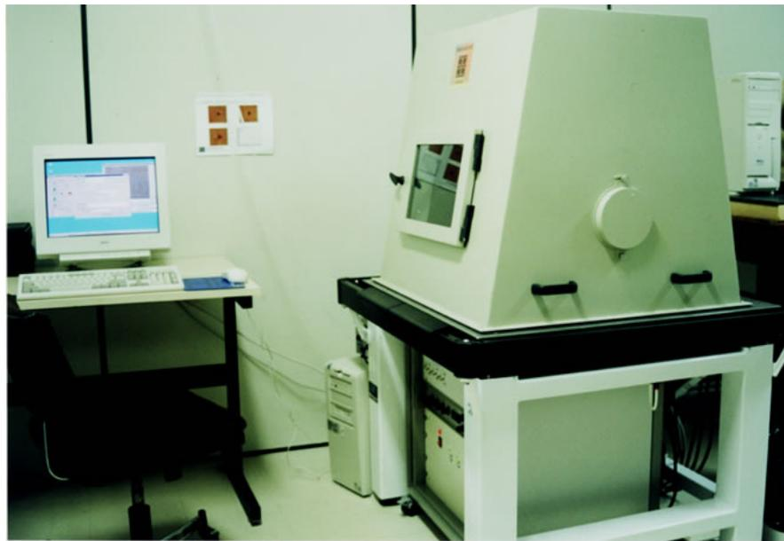
Figura 27 – Fotografia do sistema *Hysitron Triboindenter*.
