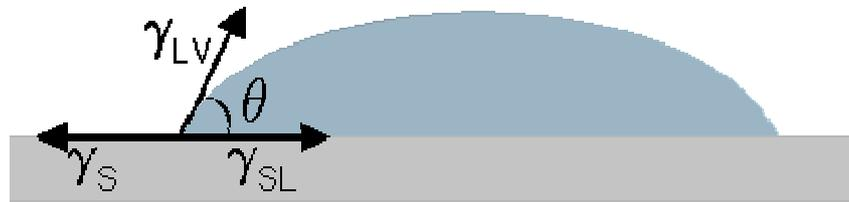
Figura 13 - Ângulo de contato  $\theta$  entre uma gota líquida e uma superfície sólida, onde  $\gamma_S$  é a energia de superfície do sólido e  $\gamma_{LV}$  a tensão superficial do líquido em equilíbrio com o vapor e  $\gamma_{SL}$  é a energia da interface sólido – líquido.
