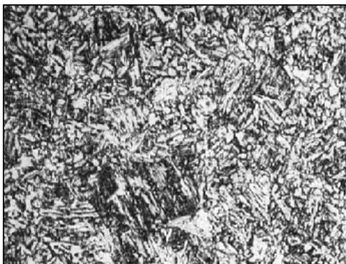
Figura 8 – Microestrutura do aço X 70 com relação ao ponto Ferrítico Martensítico do gráfico TTT. Aumento (1000 X) (RATNAPULI, 2003)
