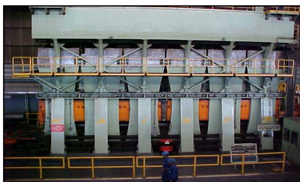
Figura 15 – Equipamento Prensa “O” (Gentileza Tenaris Confab)
