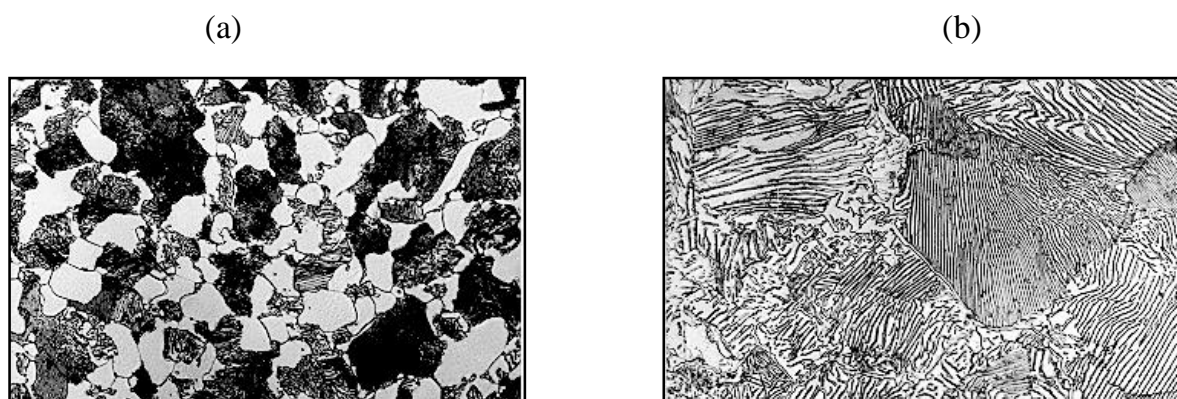
Figura 21 – Efeito da energia de soldagem na microestrutura de um aço estrutural de baixo carbono 0,4%C. (a) H = 10 kJ/mm, microestrutura: martensita e bainita e (b) H = 25 kJ/mm, microestrutura: bainita (500X) (SANTOS, 2004).
