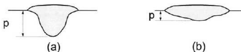
Figura 28 – Efeitos de alterações nos parâmetros de soldagem na geometria de cordões de solda depositados com uma energia de soldagem de aproximadamente 1,8 kJ/mm (esquemático). Condições de soldagem: (a) 800A, 26V e 12mm/s e (b) 125A, 26V e 1,7mm/s. (MARQUES, 2004)
