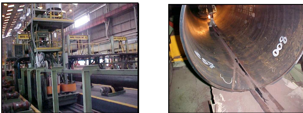
Figura 17– Equipamento de Soldagem por arco submerso (AS) interna utilizando-se três arames (Gentileza Tenaris Confab)
