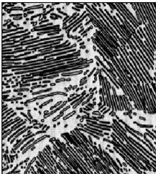
Figura 7 – Microestrutura do aço X 70 com relação a região F - P (Ferrita e Perlita) do gráfico T.T.T. Aumento (1000 X) (RATNAPULI, 2003).
