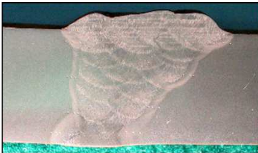
Figura 24 – Poça de fusão em formatos de gotas para o processo de eletrodo revestido. (SANTOS, 2004).
