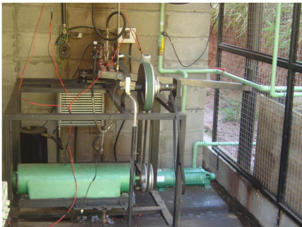
Figura 41 - Vista da turbina acoplada ao gerador.
