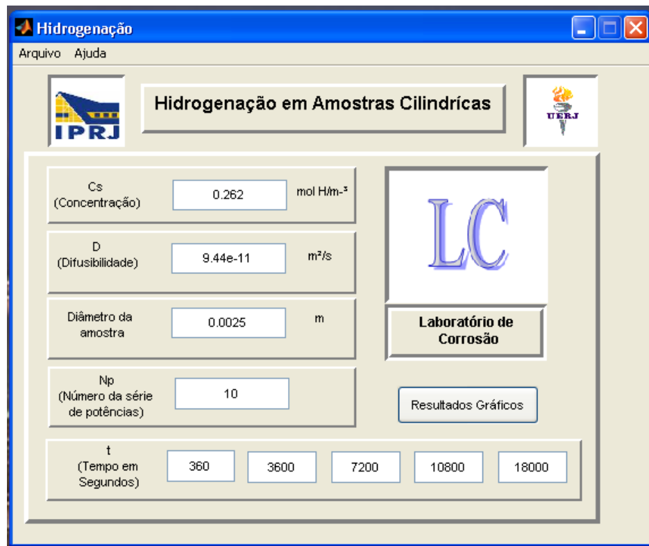
Figura 3.13 - Interface do programa computacional - MATLAB para obtenção do perfil de concentração de hidrogênio nos corpos de prova (REIS, 2009).
