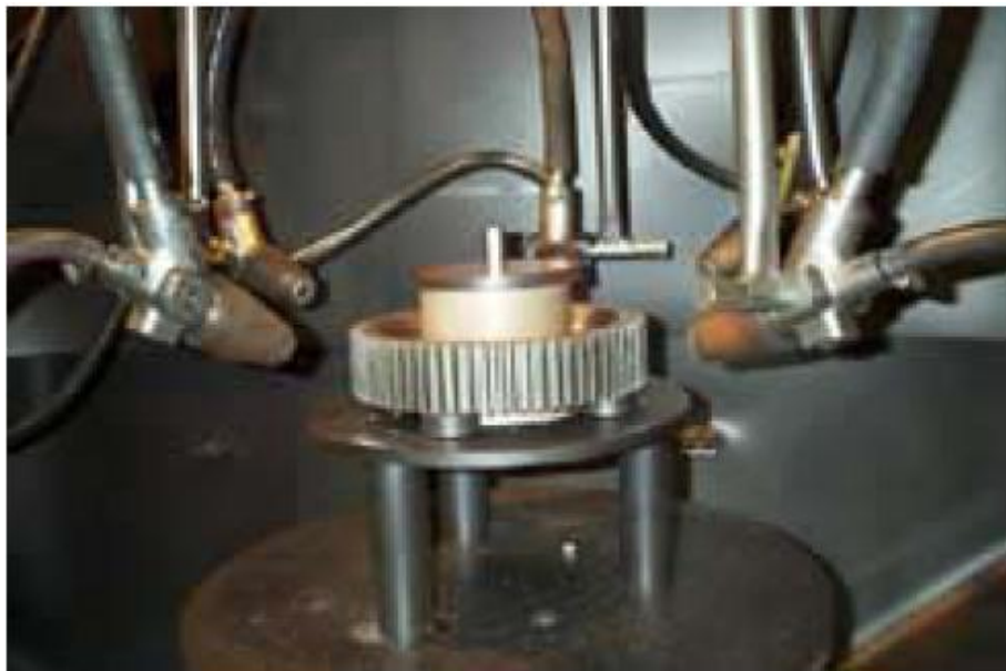
Figura 2.3 – Jateamento de partículas – shot peening para a introdução de tensões residuais compressivas em superfícies de dentes de engrenagem (CINDRA FONSECA, 2008).
