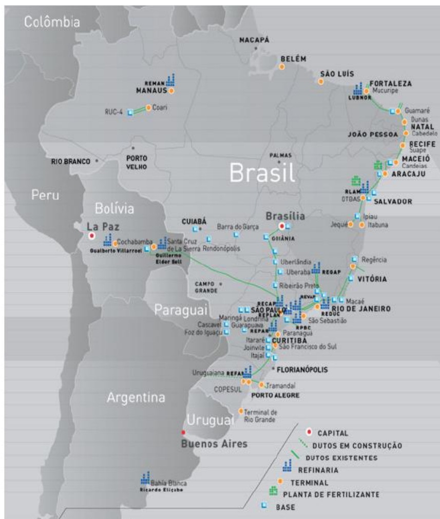
Figura 1.1 – Rede de dutos, Refinarias e Terminais (Anuário Estatístico Brasileiro do Petróleo, Gás Natural e Biocombustíveis, 2008).
