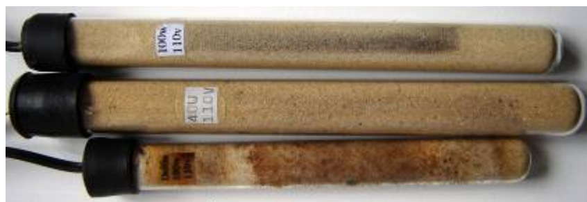
Figura 4.9 – Detalhe dos aquecedores para água do banho
