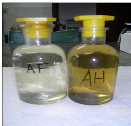
Figura 1. Soluções de AH e AF extraídos de vermicomposto pelo método ácido/base com NaOH 0,1 mol. L -1 e H 2 SO 4 20%.
