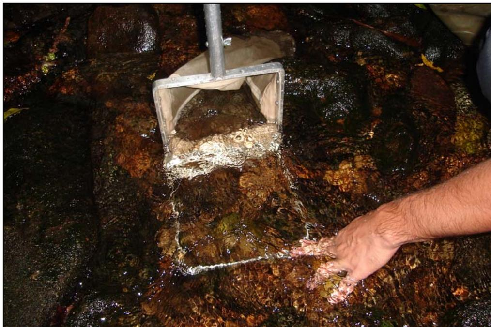
Figura 3. Amostrador de Surber usado para coleta de larvas na Serra da Mantiqueira e na Serra do Mar, com área de 0,0361 m<sup>2</sup> e malha de 0,25 mm.
