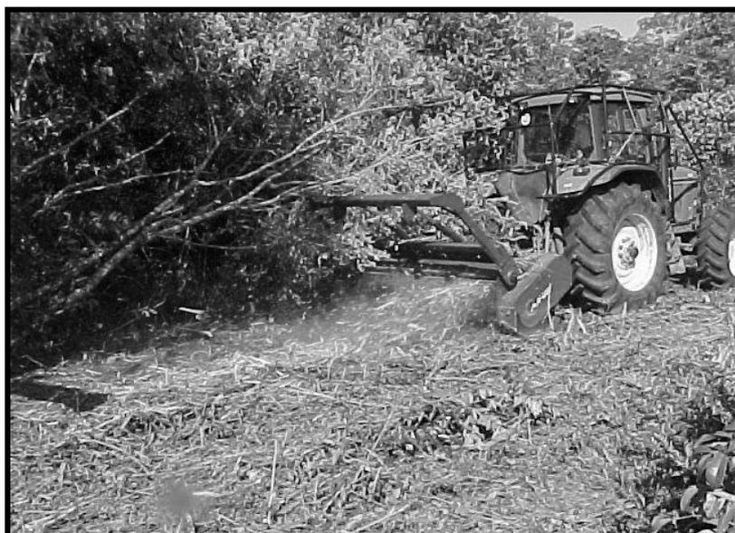
**Figura 6** – Máquina utilizada para corte e trituração da biomassa vegetal (fresador florestal modelo AHWI-600). Fonte: FREITAS, A.C.R. Evaluating Agricultural Systems
