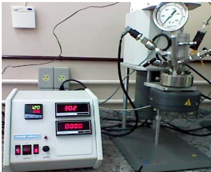
Figura 8 – Aparato experimental para as reações acima de 60 °C.
