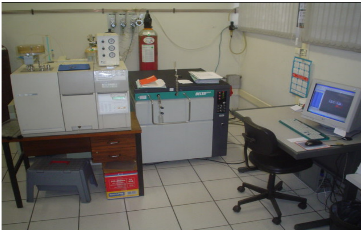
Figura 11 - Analisador elementar EA 1100 CHN e Espectrômetro de massa Delta Plus do Laboratório de Ecologia Isotópica (CENA-USP).
